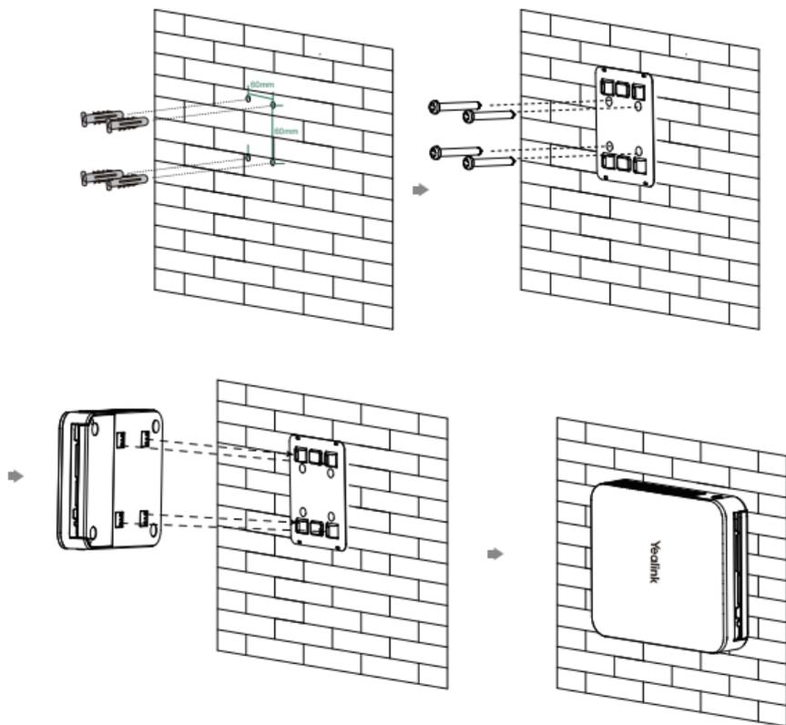
💡 固定挂墙架前, 需确认MCore要安装的方向, 挂墙架一旦固定, MCore的安装方向随之固定。
